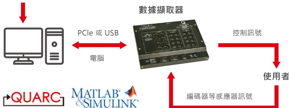
QUARC 軟體與數據擷取器結合，形成開放式的硬體迴路平台 (HIL)，讓使用者能輕鬆將各類自研對象與 MATLAB/Simulink 連接，快速進行前期演算法原型開發。
