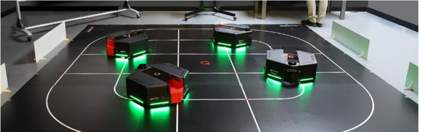
實驗室提供了一個全面且可立即部署的生態系統，配備四台 QBot 平台移動機器人，並搭配課程和實際研究範例的完整套件，旨在培養與職場接軌的技能，同時促進跨學科團隊合作。QUANSER QBot 平台具有全面的感應器套件，包含 LiDAR、Intel 景深攝影機等，並結合高性能 NVIDIA Jetson Orin Nano，可進行環境定位、路徑規劃、導航等基礎知識學習，進一步延伸至障礙物迴避、多智慧主體系統協作與應用人工智慧等主題。
